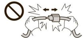
拆卸接线器、端子之类的接线时，请不要用力拉拽线束。
