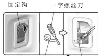
固定钩 一字螺丝刀 美纹纸 爪扣 尾箱左后下饰板
