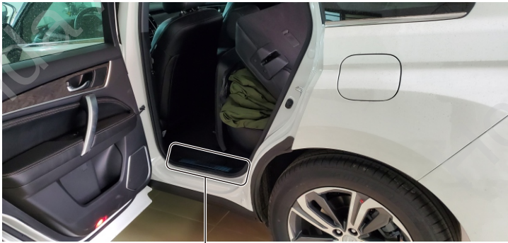
16. 拆出左侧踏板饰件。
