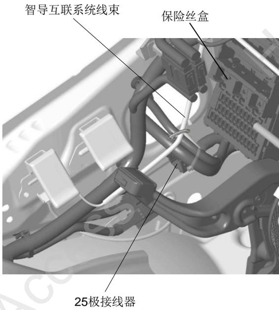
31. 剪开车辆 25 极接线器线束的软管。
