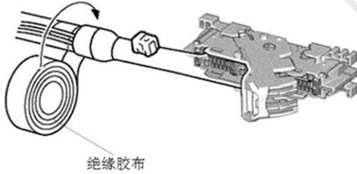
26. 连接线束的导线与车辆 28 极连接器。
