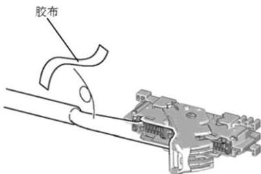
24. 连接线束的导线与车辆 27 极连接器。
