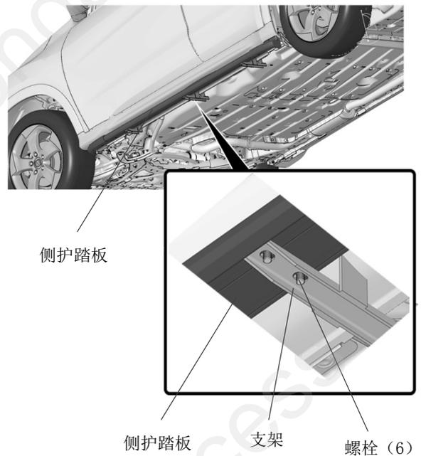
31. 拧紧暂时固定支架的8颗法兰螺栓，扭矩均为  $22\text{N} \cdot \text{m}$ 。
