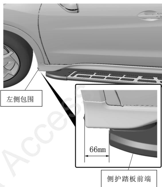
34. 拧紧暂时固定侧护踏板的6颗法兰螺母，扭矩均为  $22\text{N} \cdot \text{m}$ 。
