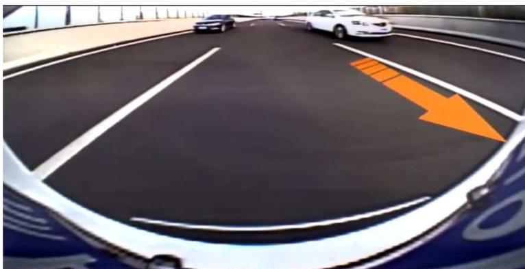
行驶途中，当开启转向灯，中控屏上显示倒车摄像头画面，若开启转向灯的同侧盲区内存在车辆，画面的该侧会出现提示箭头符并伴随着发出“滴滴”报警声。
