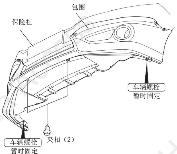
22. 轮毂的转角部分，再利用车辆自攻螺丝暂时固定。
