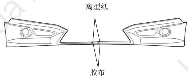
21. 临时对准包围和前下保险杠，用同包装的夹扣固定下面中间2个地方，再利用车辆螺栓临时固定下面左右2个地方。
