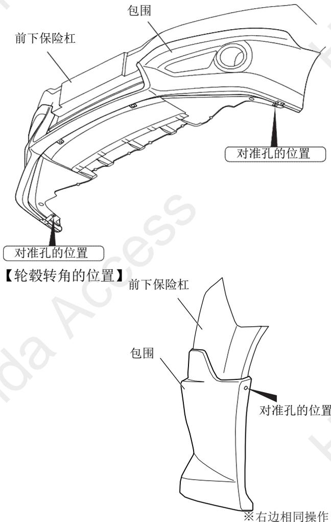
15. 对准包围下面中央2个位置的孔，在包围开孔的位置做标记。
