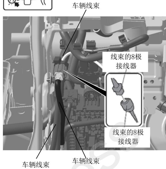
46. 固定接线器的连接部位和线束。
