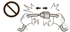
拆卸接线器、端子之类的接线时，请不要用力拉拽线束。
