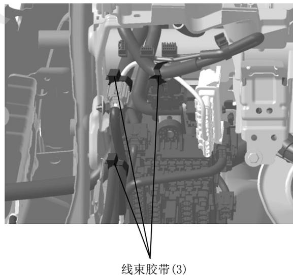
47. 拆出车辆接线器的连接。
