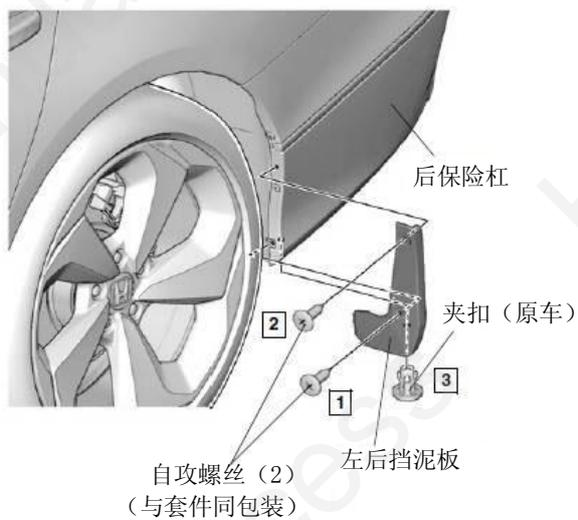
“混合动力版本车型左后挡泥板请使用套件包中的夹扣”
