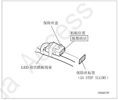
55. 拆下保险丝盒上的车辆 2 芯连接器,接上 LED迎宾踏板的 2 芯连接器。
