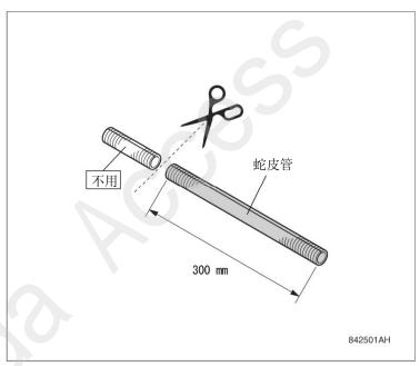
34. 把蛇皮管 300mm(12 in.)包在前LED 迎宾踏板线束的图示尺寸位置上,缠在绝缘胶带。
