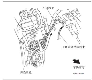
57. 把LED迎宾踏板线束的绿色胶带部对准 车辆夹扣,用线束扎带固定在车辆线束 上。
