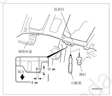
51.用电钻和 3→9mm 直径钻头在图钉孔上开 孔。
