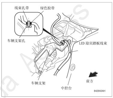
73. 用 2 根线束扎带把LED迎宾踏板线束固 定在仪表台开的孔和车辆线束上。
