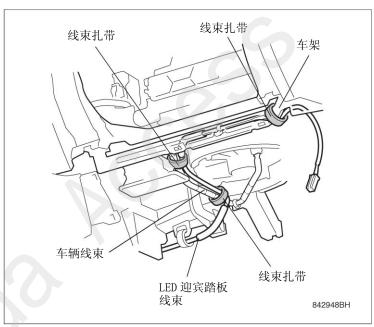
79. 用 1 根线束扎带把LED迎宾踏板的线束 固定在车辆线束上。
