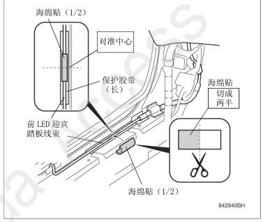
70. 用 2 根线束扎带把前LED迎宾踏板线束 和前LED迎宾踏板线束的 2 芯接头固定 在车辆线束上。
