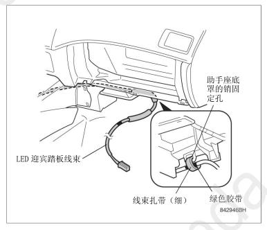
77. 把带夹扣线束扎带 A 安装在冷LED迎宾踏板线束的绿色胶带部,固定在车架的孔上。
