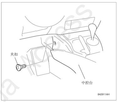
7. 拆开 2 处爪扣、5 处夹扣和 3 处挂钩,拆下右前护踏板。
