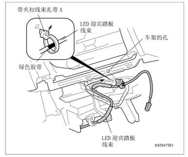
78. 用 3 根线束扎带把LED迎宾踏板线束固 定在车辆线束和车架上。
