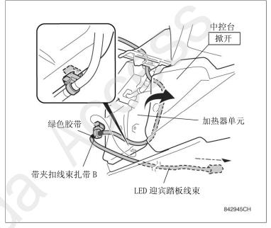
76. 把LED迎宾踏板线束的绿色胶带部对准 助手座底罩的销固定孔,用线束扎带 (细)固定。
