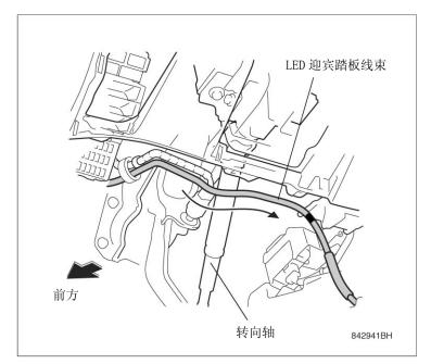
72. 把LED迎宾踏板线束的绿色胶带部对准 车辆支架孔,用线束扎带固定。
