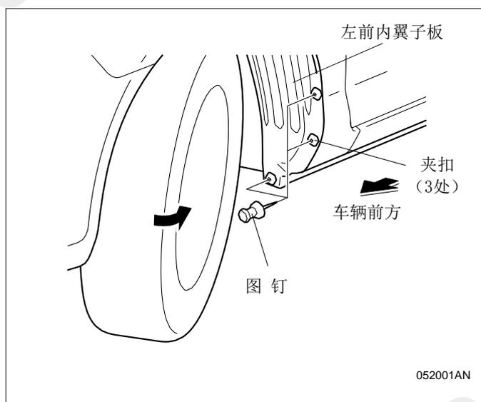
3. 用 3 颗自攻螺丝把左前挡泥板暂时固定在左前内翼子板上。
