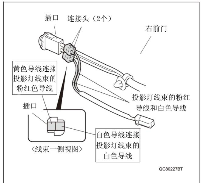
31. 用绝缘胶布把投影灯线束的粉红色导线和白色导线固定在车辆线束上。
