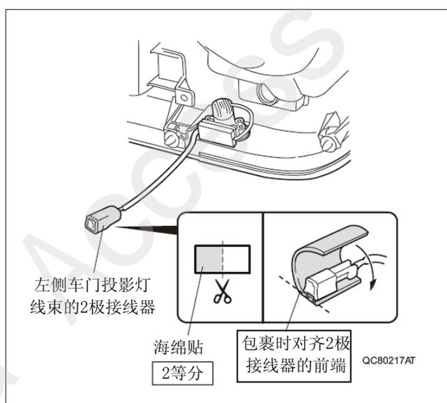
19. 用 1 条带夹扣线束胶带把左侧车门投影灯的 2 极接线器固定在左前门内门饰板上。
