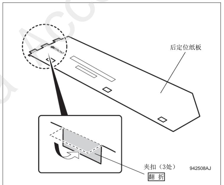
5. 把后定位纸板的2处夹扣插入左后门的前端。
