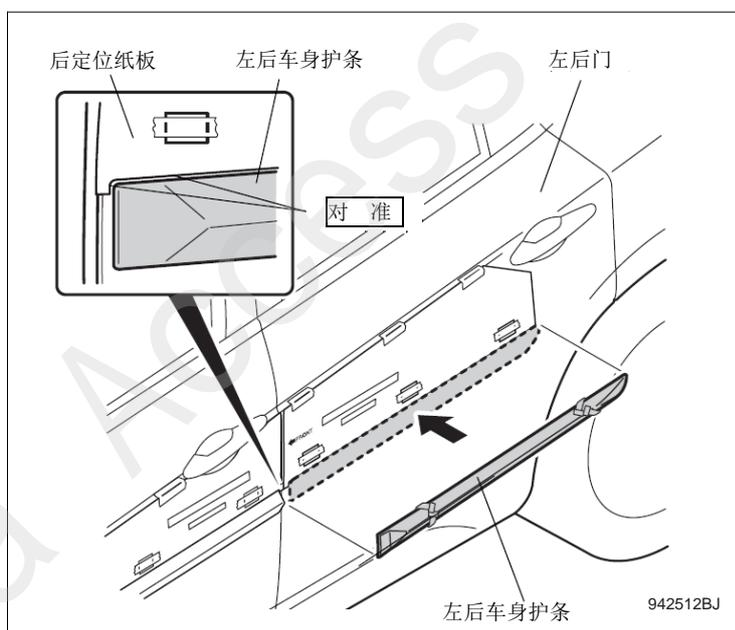
16. 一边剥开左后车身护条的2片离型纸一边用力压紧。
