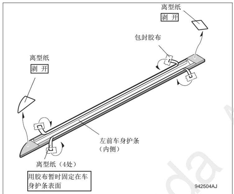
11. 如图所示，把左前车身护条对准前定位纸板，暂时固定在左前门上。
