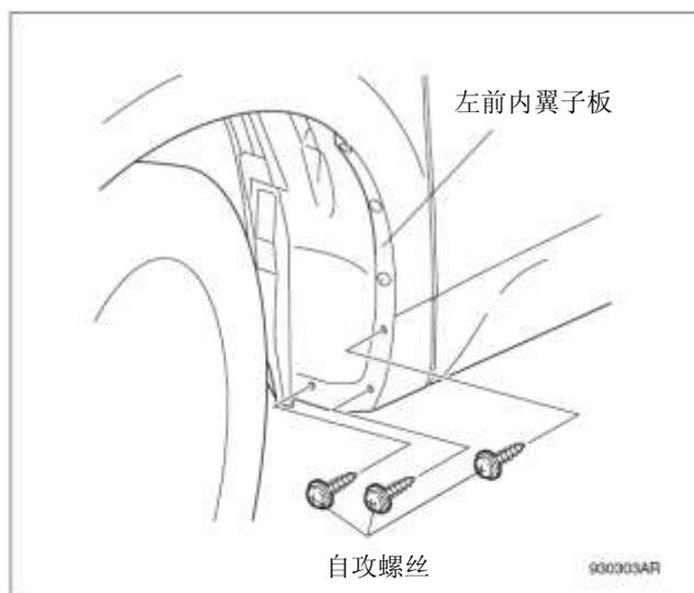
4. 用 1 颗自攻螺丝加上从车辆拆卸下来的 3 颗自攻螺丝（再使用）按照图示的顺序把左前挡泥板固定好。
