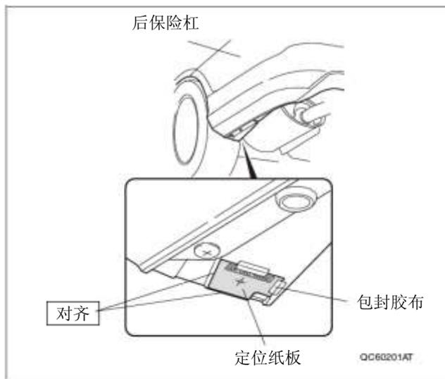
9. 使用图钉在定位纸板的1处孔位做记号。
