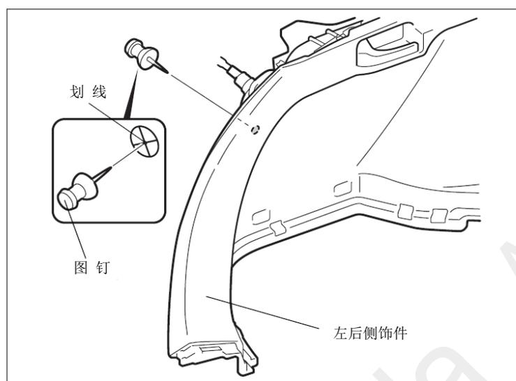
20. 如图所示用手枪钻把图钉刺穿的孔钻开。
