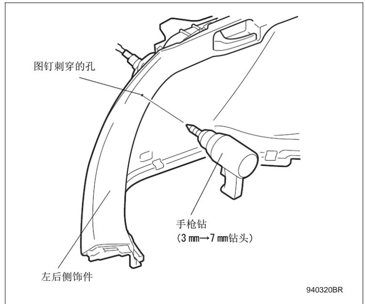
21. 如图所示用手枪钻在图示的位置7mm的孔处钻开一个12.5mm的孔。
