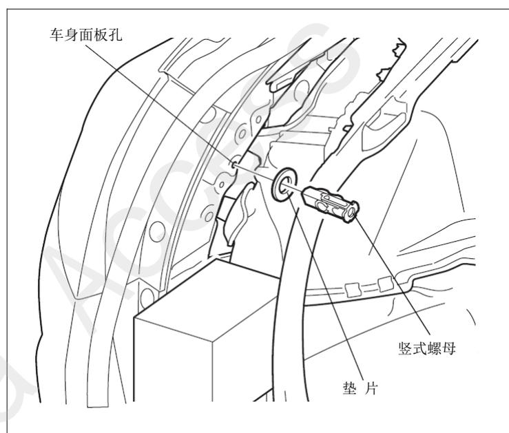
19. 用图钉在左后侧饰件内侧的划线中心刺穿1个孔。
