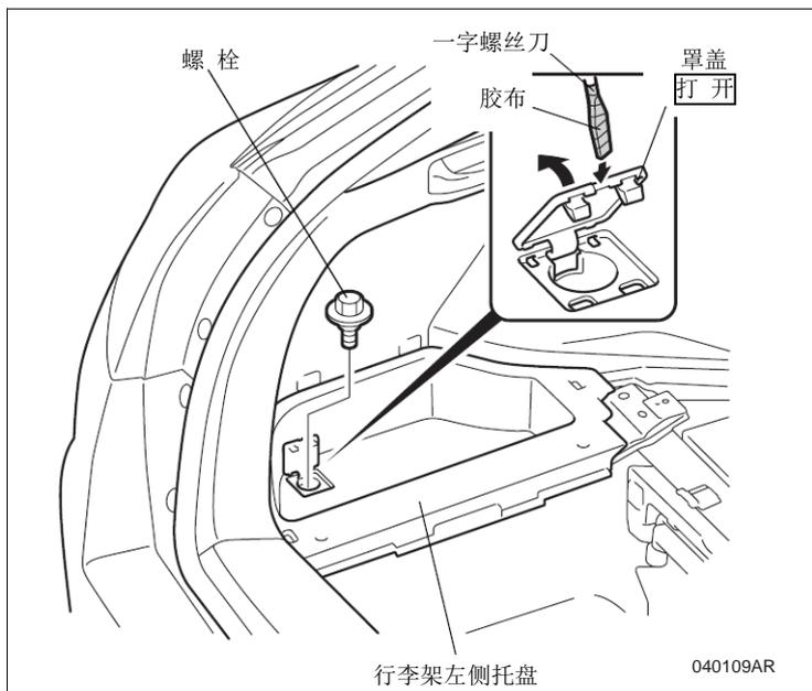
5. 拆开2处钉扣，取出行李架左侧托盘。
