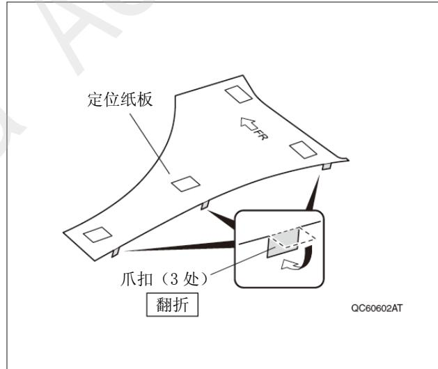
2. 把定位纸板的3处爪扣插入左前翼子板的后端。
