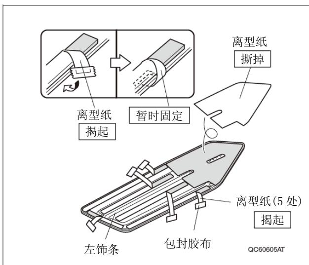
7. 如图所示把左饰条对齐定位纸板, 暂时固定在左前翼子板。
