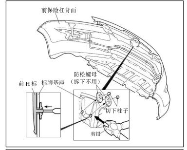
5. 将装配前 H 标的地方(前基座)用清洁剂 清洗,擦干后将镀金的前 H 标装在前基座 上,将防松螺母套在 H 标的柱子上并锁住 H 标(注意装好后检查 H 标是否有松动)。
