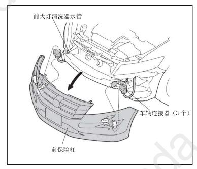
4. 在前保险杠背面,用剪钳剪断标牌基座上 H标的2根柱子,取下锁住H标的2个防 松螺母,拆下原装的前H标。
