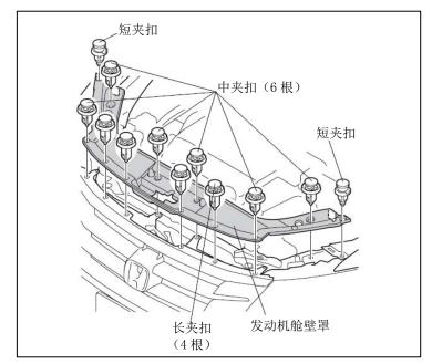
2. 拆开 8 根夹扣、4 根螺栓和 2 根自攻螺钉。
