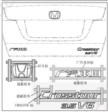
8. 用风筝线(丝线)按图示箭头方向分别在 "后 H 标"、"广汽本田标"和"CROSSTOUR 标"的粘贴面拉动丝线,使粘贴面的双面 胶脱落,然后取下"后 H 标"、"广汽本田 标"和"CROSSTOUR 标"3块标牌,最后 在取下3块标牌的位置用脱脂清洁剂清 洁干净。
