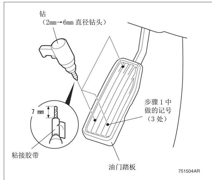
3. 在油门踏板左侧的 2 处孔上安装上支架、
