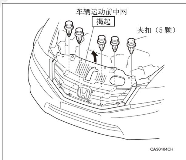
5. 拆开 5 处卡钩，拆卸下车辆运动前中网。
