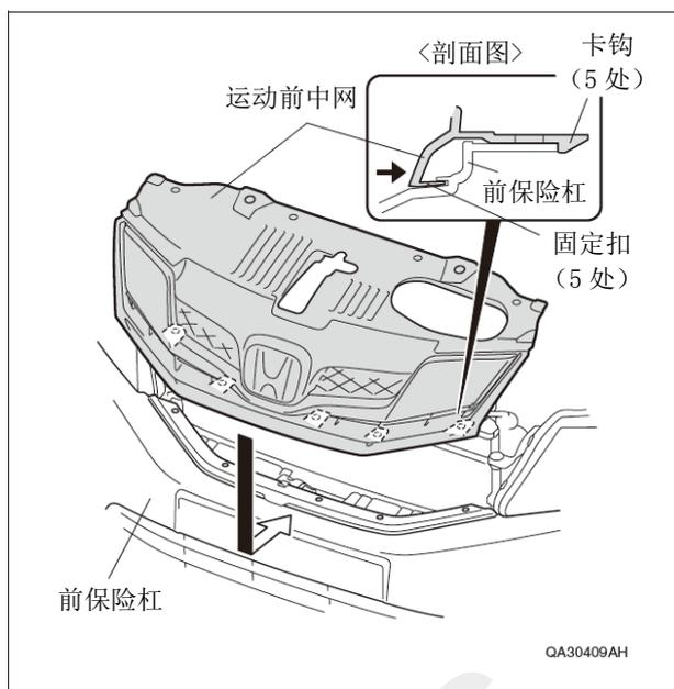
8. 把拆卸下来的 2 个金属环套安装在运动前中网上。
