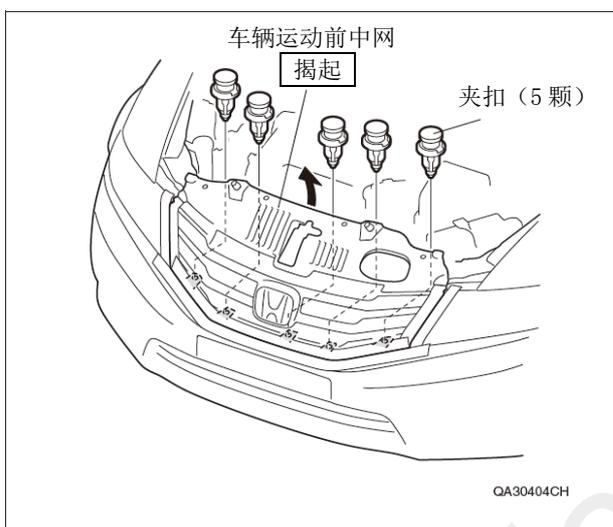
7. 拆开 5 处卡钩，拆卸下车辆运动前中网。
