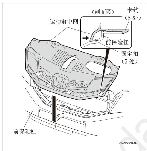
10. 把拆卸下来的 2 个金属环套安装在运动前中网上。
