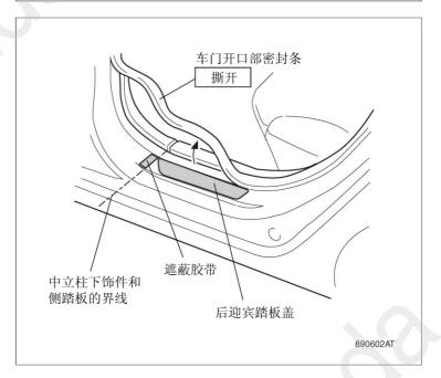
10. 撕开后迎宾踏板盖内侧的 4 处离型纸, 用遮蔽胶带暂时贴在表面上。
