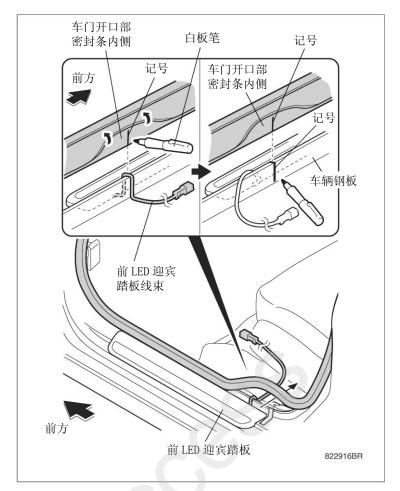
53. 以白板笔的记号为中心,按照图示尺寸 剪切车门开口部密封条。
