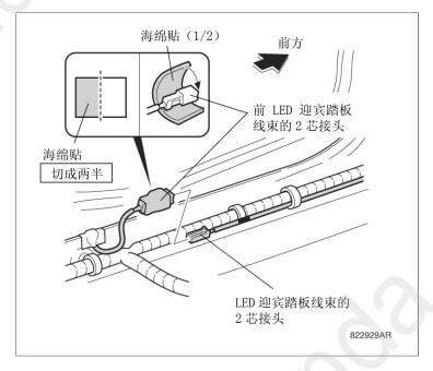
68. 用 2 根线束扎带把前 LED 迎宾踏板线束的 2 芯接头和前 LED 迎宾踏板线束固定在车辆线束上。
