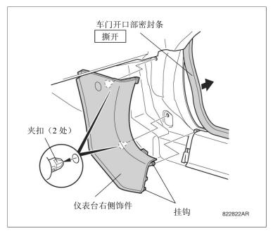
6. 撕开车门开口部密封条, 拆开 2 处夹扣和 2 处爪扣, 拆下右前侧护踏板。
