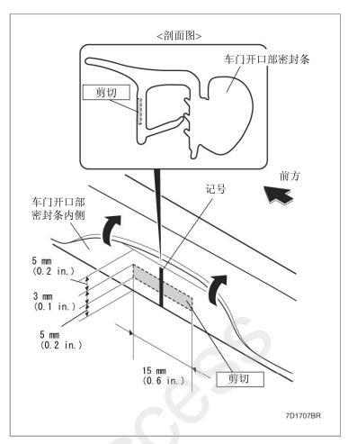
31. 从车门开口部密封条的切口拔出 3 根铁芯。
