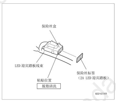
9. 从保险丝盒上拆开车辆 8 芯接头的连接,把LED迎宾踏板线束的 8 芯接头夹塞连接上。
