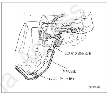
15. 把 LED 迎宾踏板线束的绿色胶带部对准 机舱壁的孔,用线束扎带固定。
