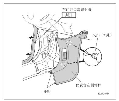
3. 撕开车门开口部密封条,拆开 2 处夹扣和 2 处挂钩,拆下左前侧护踏板。
