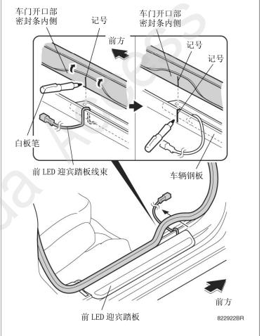
30. 以白板笔的记号为中心,按照图示尺寸剪切车门开口部密封条。
