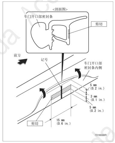
54. 从车门开口部密封条的切口拔出 3 根铁芯。
