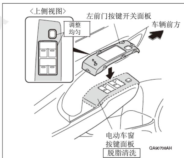
15. 一边撕掉左前门按键开关面板的 7 片离型纸，一边用力压紧面板整体。
