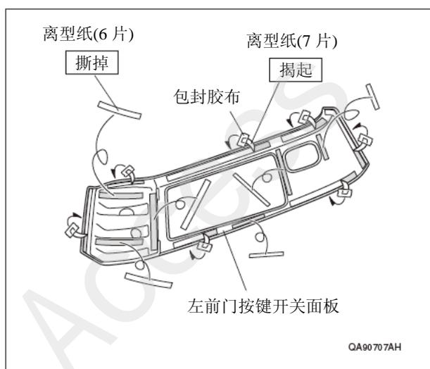
13. 确认左前门按键开关面板的粘贴位置，用脱脂洗剂清理干净。
