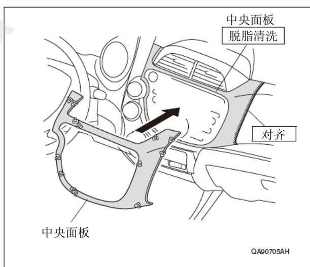
10. 一边撕掉中央面板的 13 片离型纸，一边用力压紧面板整体。
