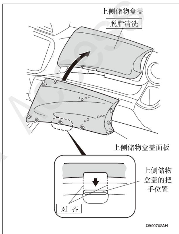
5. 一边撕掉上侧储物盒盖面板的 9 片离型纸，一边用力压紧面板整体。
