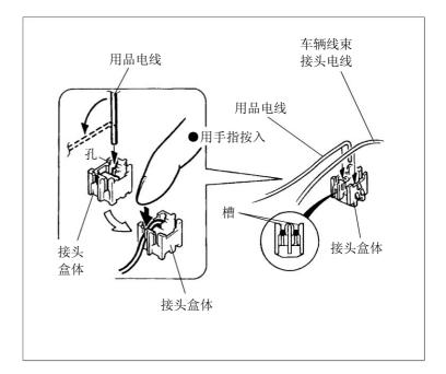
2. 盖上接头盖子,用手按压盖子扣上(第1级),防止电线脱落,然后用夹钳扣好(第2级)。
