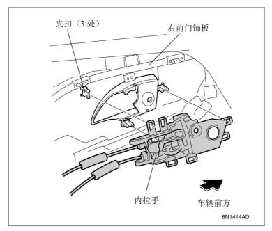
8. 把步骤 7 中拆下的内拉手用粘贴胶带固定在右前门上。
