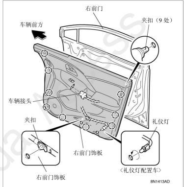
7. 拆开 3 处夹扣,从右前门饰板上拆下内 拉手。
