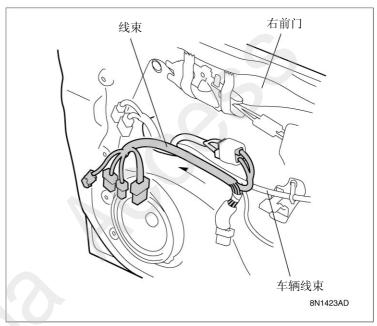
21. 把线束的 13 芯接头和 2 芯接头连接在 2 处车辆接头上。
