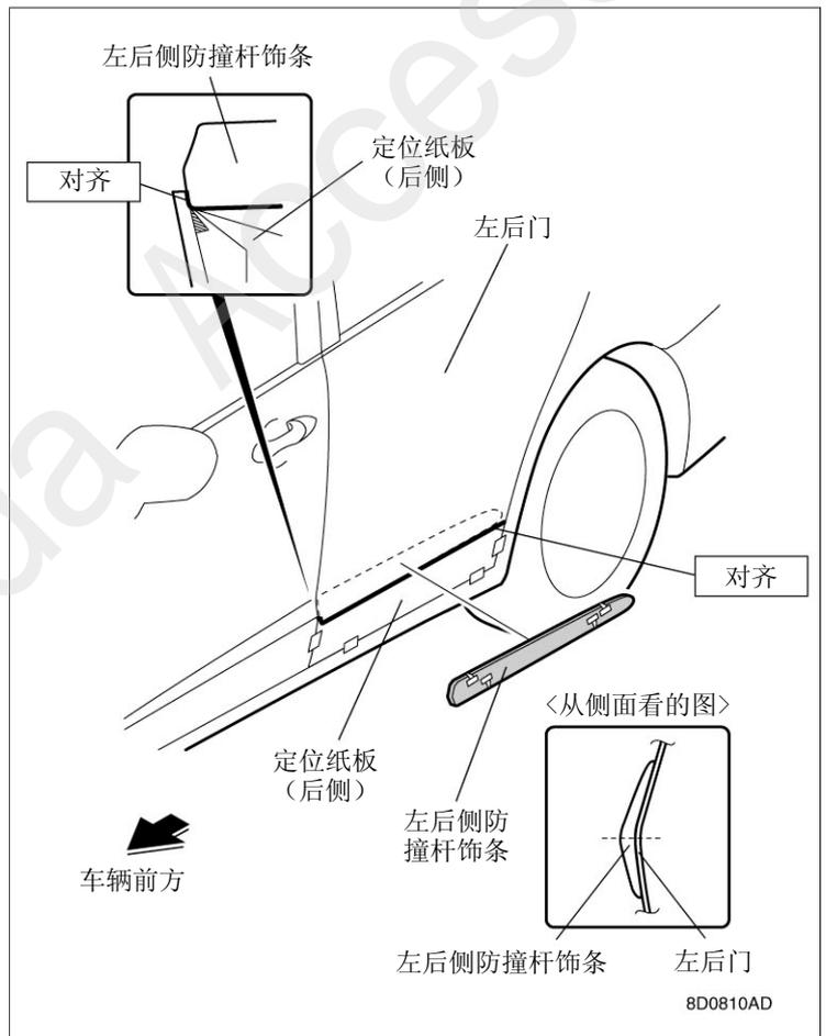
14. 一面剥掉左后侧防撞杆饰条正面暂时固定着的 4 处离型纸，一面充分压紧。
