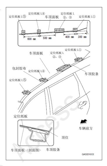
4. 在定位纸板的图示位置涂抹底涂料,并干燥 10 分钟以上。
