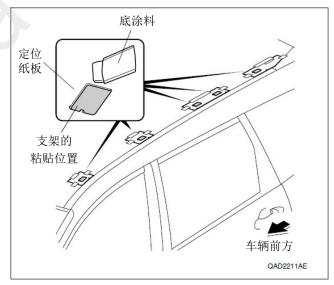
5. 撕掉支架(5个)的离型纸,对齐定位纸板的 粘贴位置粘贴好。
