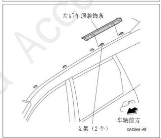
8. 对齐左后车顶饰条的安装位置,按照图示顺序 撕掉贴纸,用力压紧。
