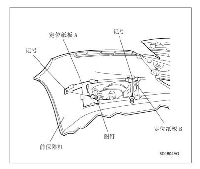
10. 用电钻在步骤 8 中做的 2 处记号上,用 3mm 直径钻头开孔。然后用 6mm 直径钻 头开孔。
