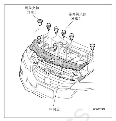
2. 拆下2根自攻螺钉、4根夹扣、8根带弹簧夹扣和4根台阶式螺栓。
