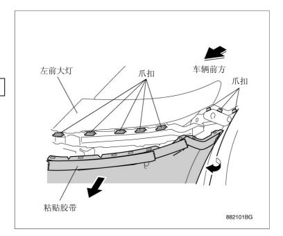
6. 拆开车辆接头的连接, 拆下前保险杠。
