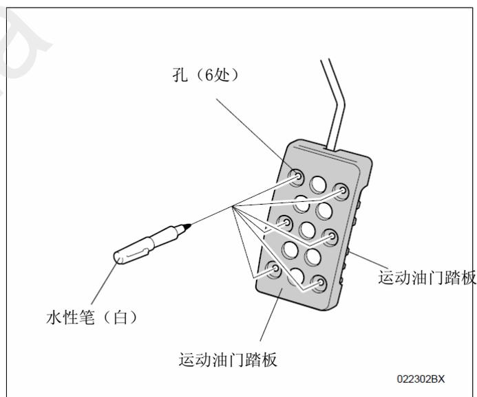
3. 用安装 3mm 口径钻头的电钻把步骤 1 中做的 6 处记号钻开成孔。
