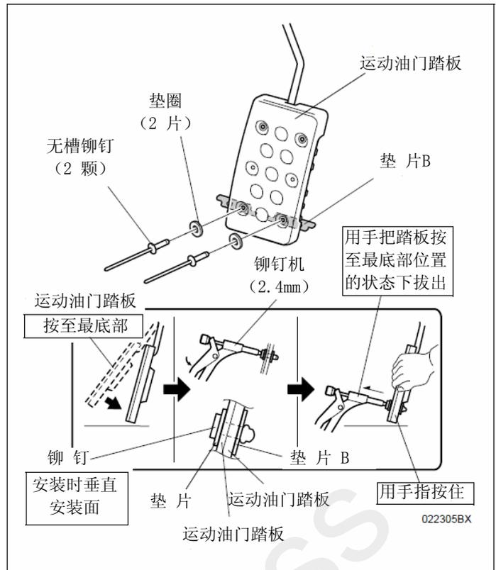
11. 用力拉出安装在运动油门踏板的2个垫圈B的一部分。
