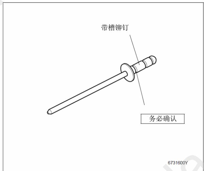
19. 用4颗带槽铆钉把刹车踏板罩和踏板垫固定在刹车踏板的底座上。
