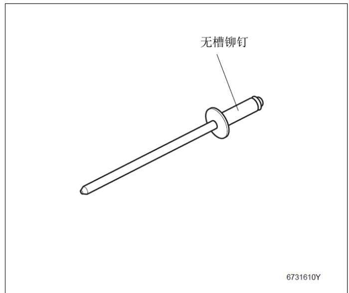
6. 把运动油门踏板对齐运动油门踏板，用 1 颗无槽铆钉和 1 个垫圈把踏板罩固定在踏板底座上。
