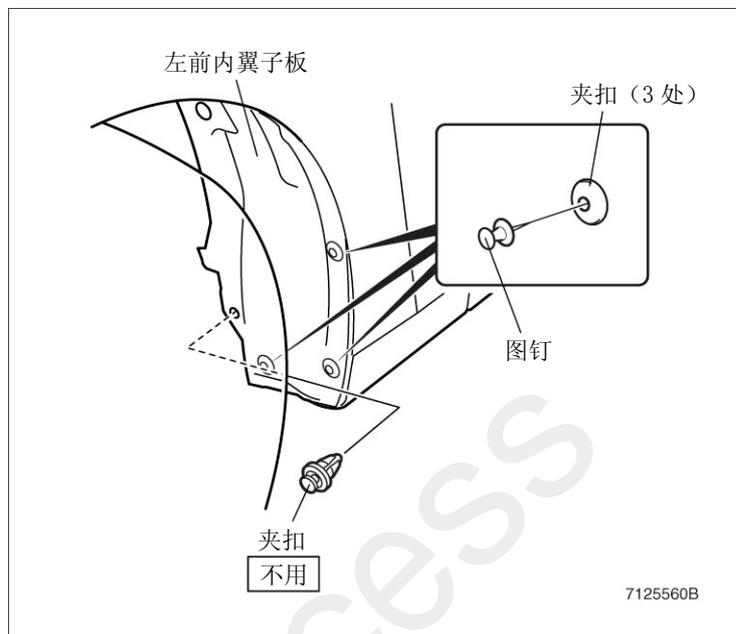
4. 用 1 根夹扣和 3 根自攻螺钉把前挡泥板（左）暂时固定在左前内翼子板上。
