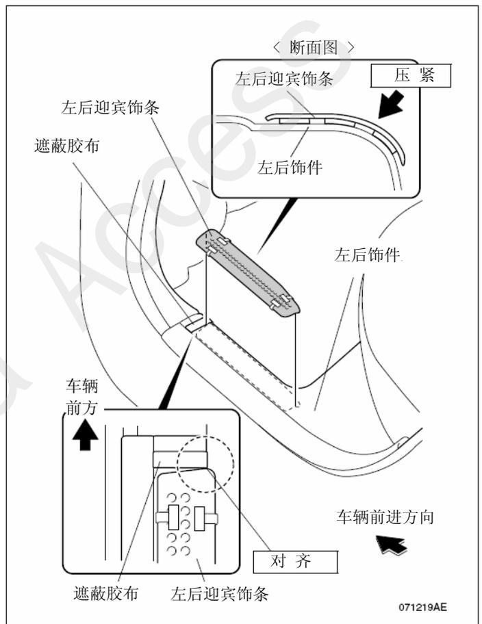
15. 把暂时固定在左后迎宾饰条表面的4处离型纸按图示顺序一边剥开一边用力压紧。
