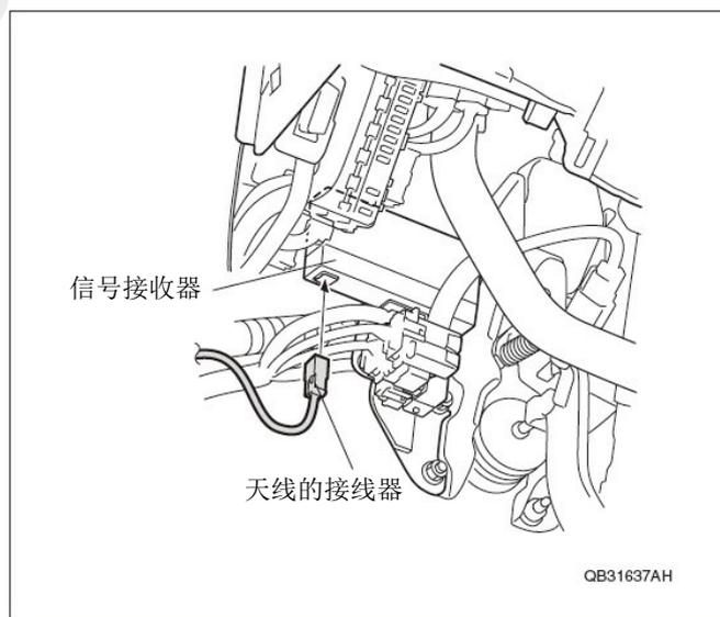
73. 把天线的配线扎起来，用 1 条线束胶带把引擎启动器线束和天线的配线绑在车辆线束上固定好。
