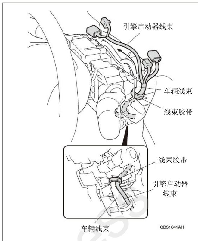
77. 拆出车灯开关的车辆 12 极接线器，然后连接到引擎启动器的 12 极接线器上。
