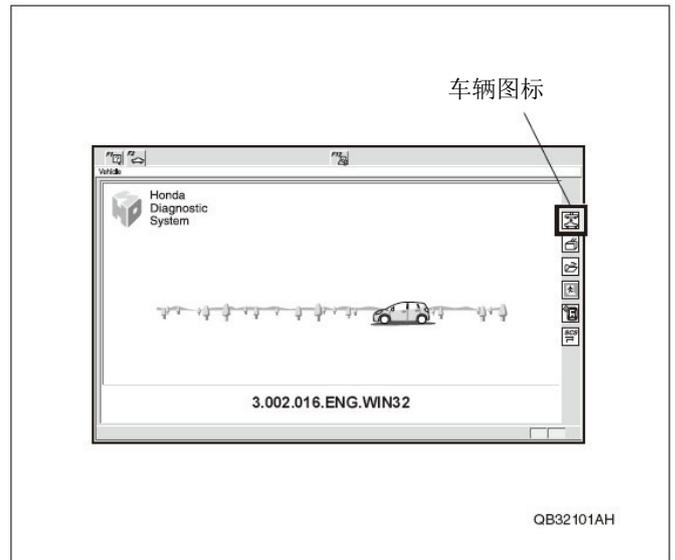
5. 输入车架号，里程表，驱动，型号，年款，点击  图标。
