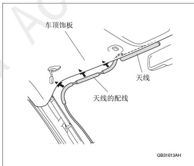
38. 铺放好天线的配线，用 4 条线束胶带把天线的配线固定在车辆线束上。
