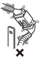
从固定架上拆卸接线器时，务必装回原位，全部作业完成后须再次确认是否有脱落。
