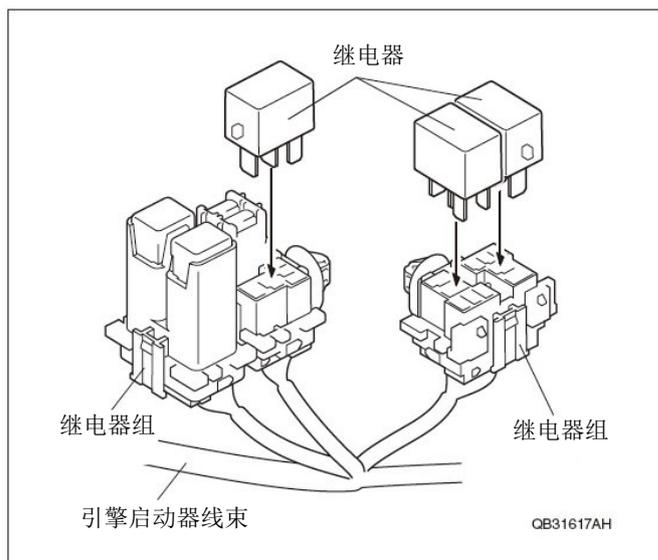
43. 把引擎启动器线束的 28 极接线器连接到信号接收器上。
