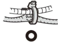
用胶带绑紧线束，不要让线束摇晃。拆卸夹扣后必须装回原位。
