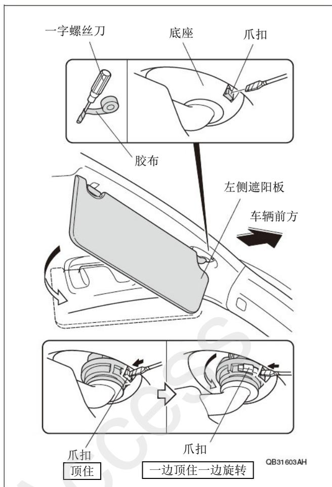
9. 拆开车辆接线器的接线，拆出左侧遮阳板。
