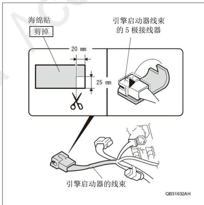
66. 拆出保险丝盒的车辆 5 极接线器，然后与引擎启动器线束的 5 极接线器连接。
