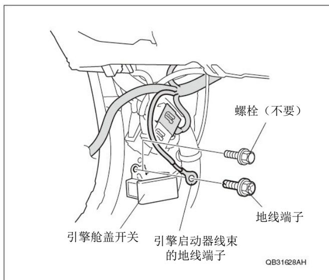
60. 用 1 条线束胶带把引擎启动器线束固定在车辆线束上。
