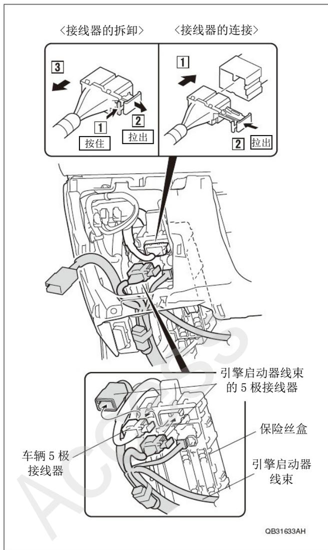
68. 如图所示，用 1 条长线束胶带把引擎启动器线束，引擎启动器线束的 5 极接线器以及天线的配线都固定在车辆线束上。
