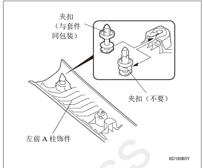
3. 夹扣垂直对准左前 A 柱饰件的孔，在左前 A 柱饰件的“SIDE CURTAIN AIRBAG”字样位置轻轻按压，安装好夹扣。
