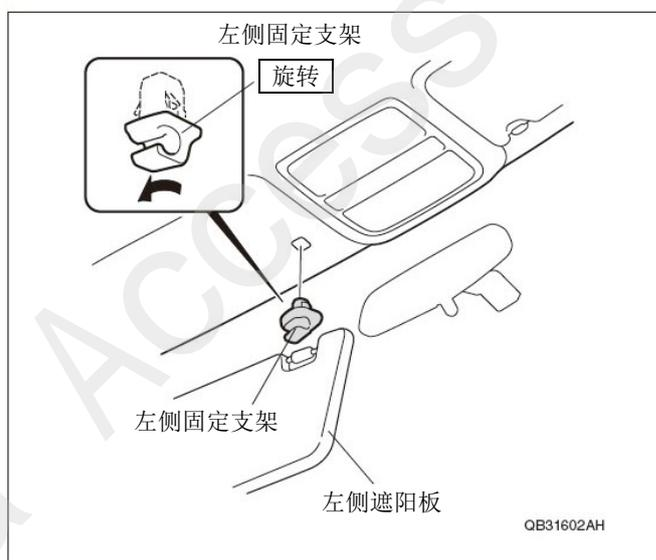
7. 用一字螺丝刀顶住左侧遮阳板的底座前侧的爪扣。
