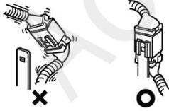
将接头从撑条上拆下后，请务必返回原状。结束作业时，请再次检查是否遗漏
