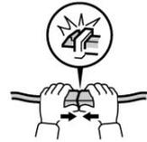
连接接头的端子时，应插入到切实锁紧为止。
