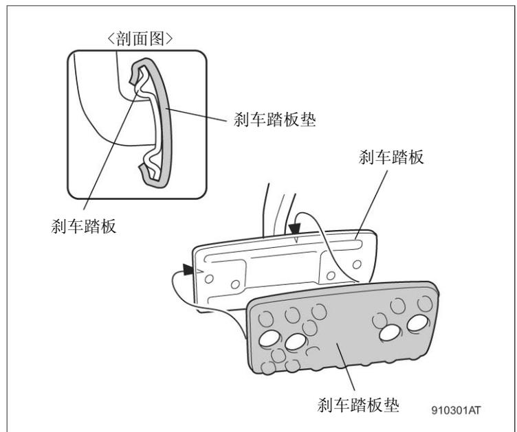
8. 把刹车踏板盖安装在刹车踏板垫上，用 4 根长铆钉固定。
