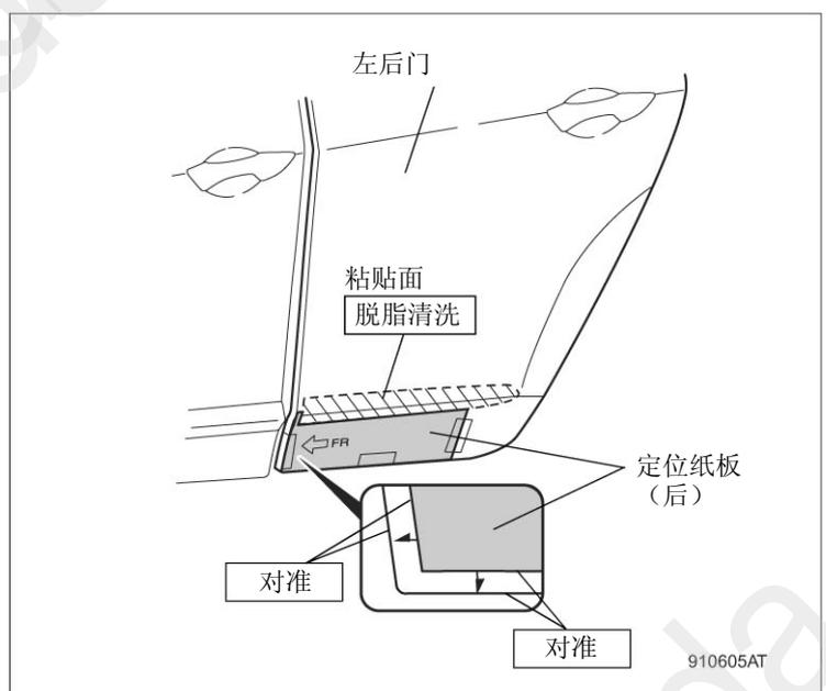
11. 撕开车身护条（后/左）背面的 4 处离型纸，用遮蔽胶带暂时固定在表面。
