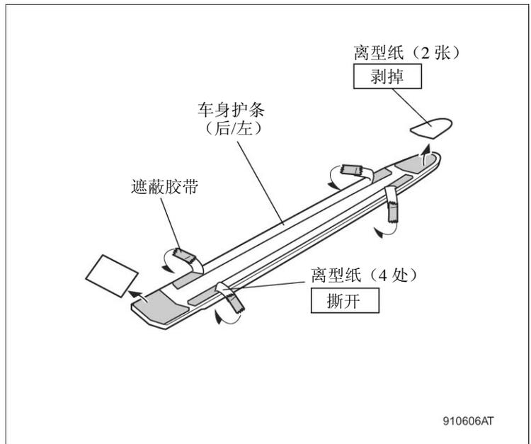
13. 把车身护条（后/左）对准定位纸板（后），固定在左后门上。
