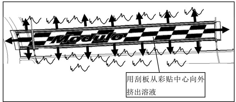
12. 用中性洗涤液在车身上喷湿 L4 彩贴的粘贴区域。然后，一面剥掉 L4 彩贴的离型纸，一面喷湿彩贴的粘贴面。
