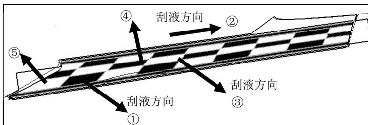
18. 所有彩贴充分压紧后用反转 180 度的角度缓慢剥开保护膜。
