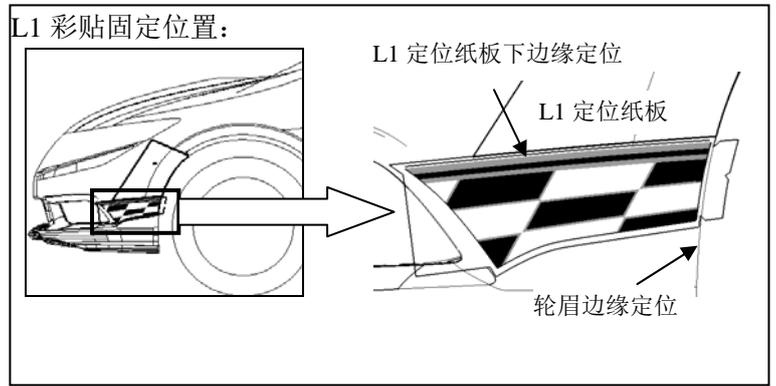
5. 彩贴初步固定后，移除 L1 定位纸板。
