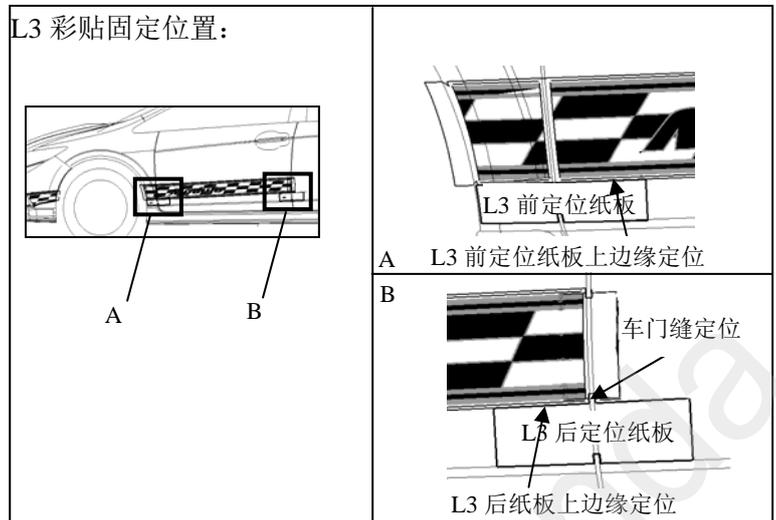
10. 初步固定 L3 彩贴后，移除 L3 前定位纸板、L3 后定位纸板。
