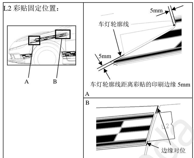
初步固定 L2 彩贴后，用刮板按照右图的方向和顺序刮出溶液。
