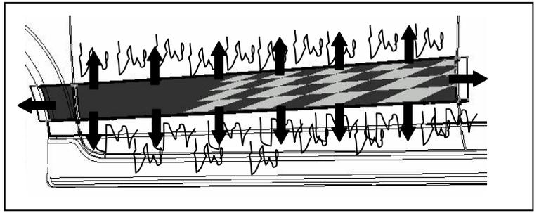
12. 用中性洗涤液在车身上喷湿 L4 彩贴的粘贴区域。然后，一面剥掉 L4 彩贴的离型纸，一面喷湿彩贴的粘贴面。
