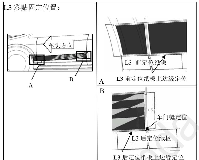
10. 初步固定 L3 彩贴后，移除 L3 前定位纸板、L3 后定位纸板。
