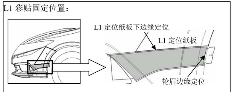
5. 初步固定 L1 彩贴后，移除 L1 定位纸板。
