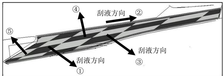
18. 所有彩贴充分压紧后用反转 180 度的角度缓慢剥开保护膜。
