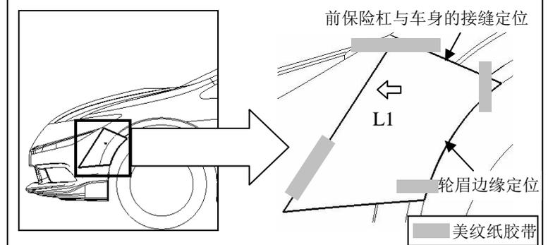
3. 定位纸板装完后，用中性洗涤剂在车身上喷湿 L1 彩贴的粘贴区域。然后，一面剥掉 L1 彩贴离型纸，一面喷湿彩贴的粘贴面。
