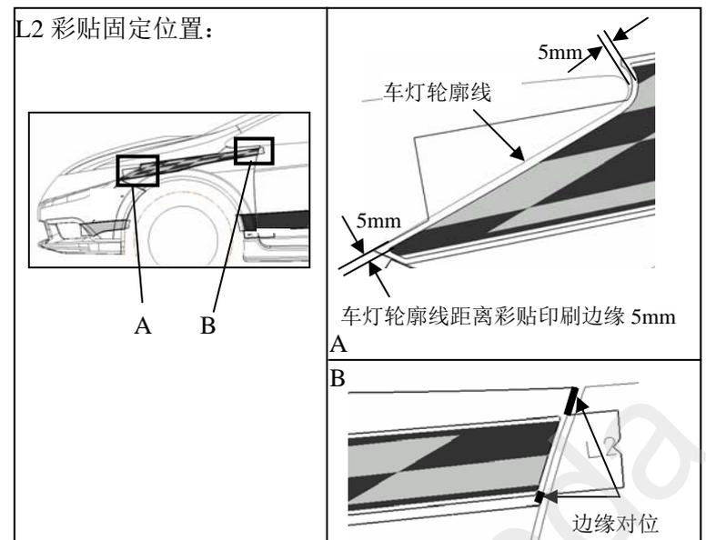
17. 初步固定 L2 彩贴后，用刮板按照右图的方向和顺序刮出溶液。
