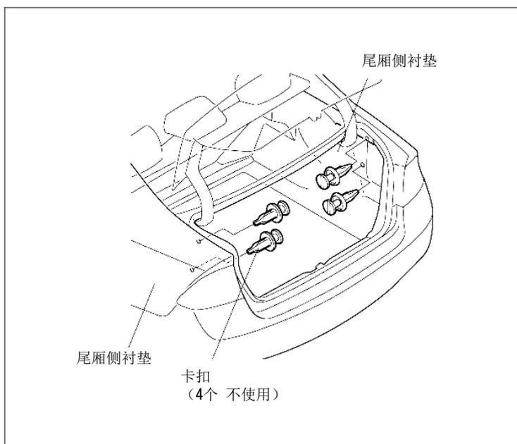
2. 戴上保护眼镜，用电钻在步骤1所拆下的4个夹扣的安装孔上开直径8mm的孔。
