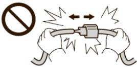
拆卸接线器、端子之类的接线时，请不要用力拉拽线束。
