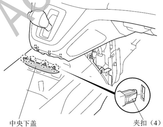
5. 拆下中央控制台面板。
