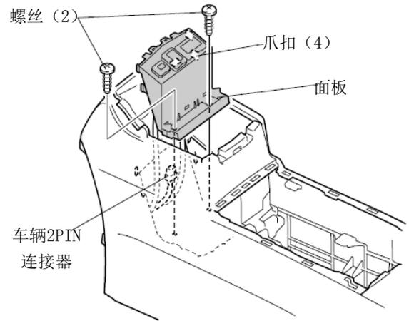
19. 拉出车辆的 2PIN 连接器。
