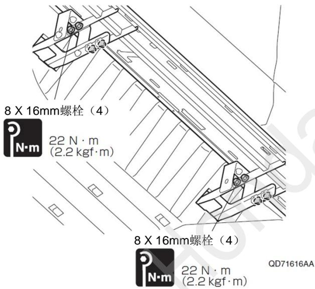
30. 确认侧护踏板的安装状态。
